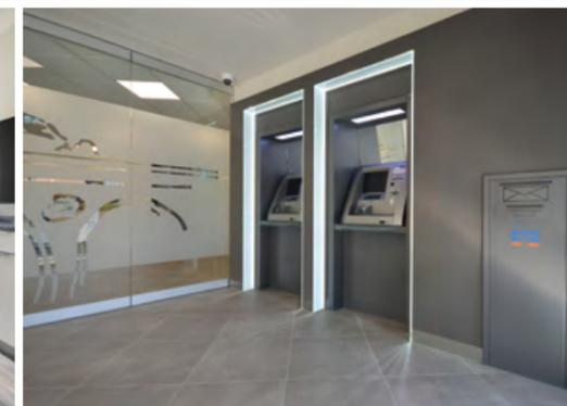
Automaten werden mit LED-Technik beleuchtet und wurde in einem RC3 Wandsystem verbaut.
