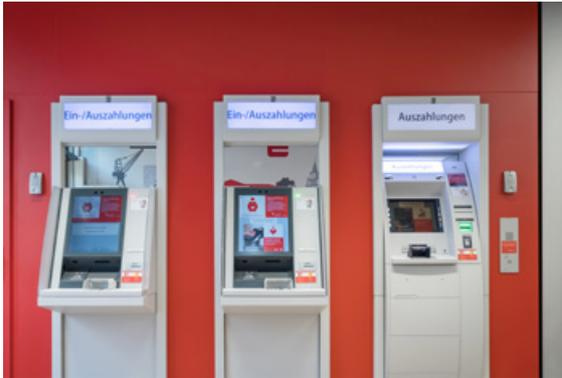
Unterfahrbare Geldautomaten in einer RC3 Wandkonstruktion
