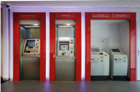
Indirekte LED-Beleuchtung mit variabler Farbeinstellung
